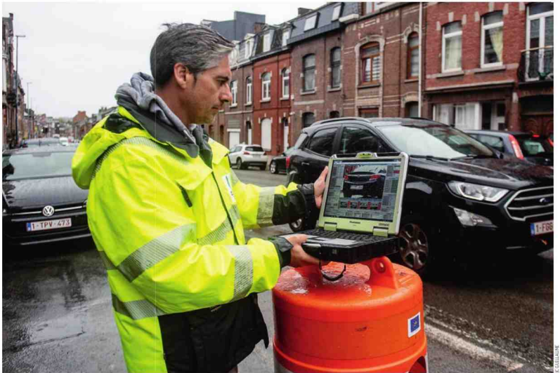
Le dispositif permet de mesurer à distance les gaz polluants d'un véhicule pour les comparer aux données d'homologation.
